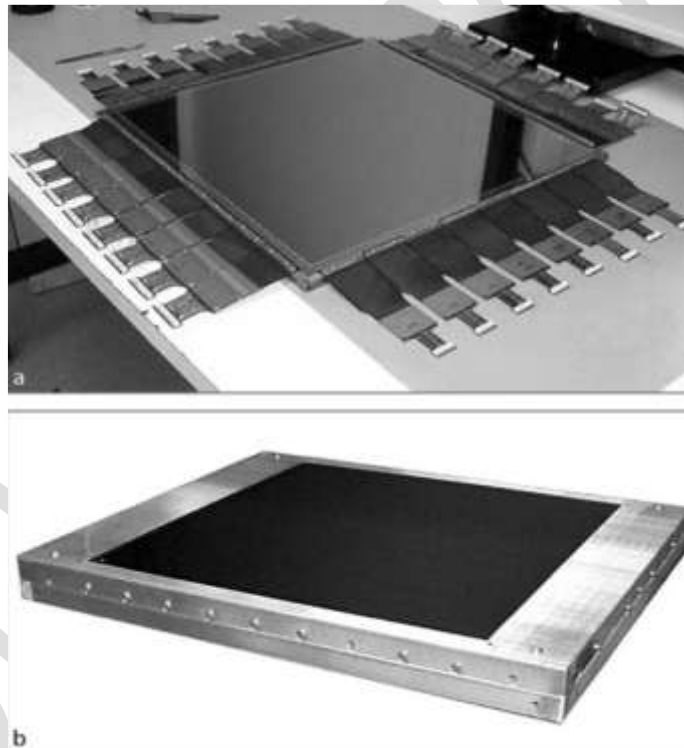
شکل 6-15. آشکارسازهای صفحه-صاف با ابعاد 41 \times 41 سانتی متر و رزولوشن 2048 \times 2048 پیکسل. ردیف بالا: صفحه آشکارساز با کابل های اتصالی جهت انتقال داده ها، ردیف پایین: صفحه آماده شده جهت استفاده در اسکنرها
